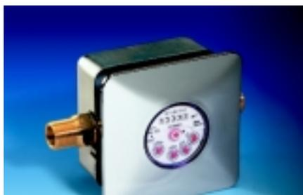
Прочная, нержавеющая коробка для скрытого монтажа из стального листа с встроенным адаптером. Доступ к присоединительным штуцерам счётчика возможен после снятия розетки. Посредством специальных компенсационных колец достигается установка счётчика на необходимое расстояние от розетки. Легкая установка и демонтаж счётчика обеспечиваются двумя накидными гайками.
