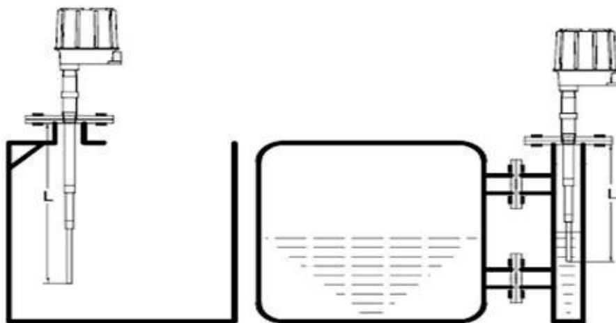
Установка в открытом резервуаре на кронштейне
